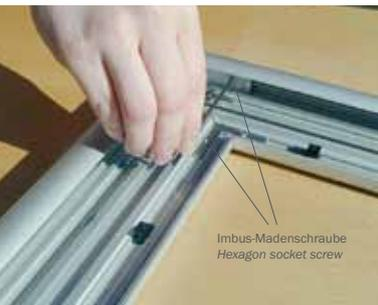
Danach werden die Profile mittels dem beiliegenden Imbusspanner und den 5 mm Madenschrauben fixiert.
