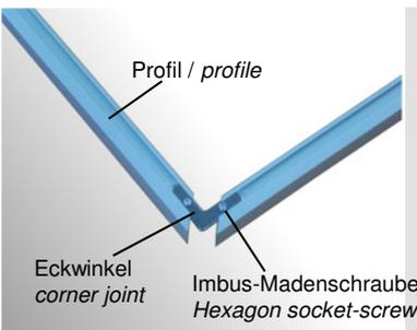
Die vier Eckwinkel werden zunächst in zwei gleichlange Rahmenprofile (jeweils einer) seitlich in die dafür vorgesehenen Profilkammern eingeschoben. Ebenso werden die weiteren Profilteile auf die Winkelverbindung aufgeschoben.
