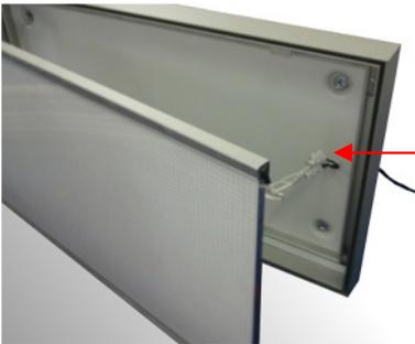
Während der Montage sollte die Elektrik getrennt werden, damit Sie mehr Platz für die Befestigung haben. Die Wandmontage sollte über die vorbereiteten Wandbohrungen erfolgen. Achten Sie beim späteren Verbinden auf die richtigen Anschlüsse um eine Beschädigung der LED-Technik zu verhindern. (Verpolung)
